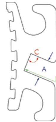
**Fig. 4:** Măsurătorile de profil a slotului bracketului
